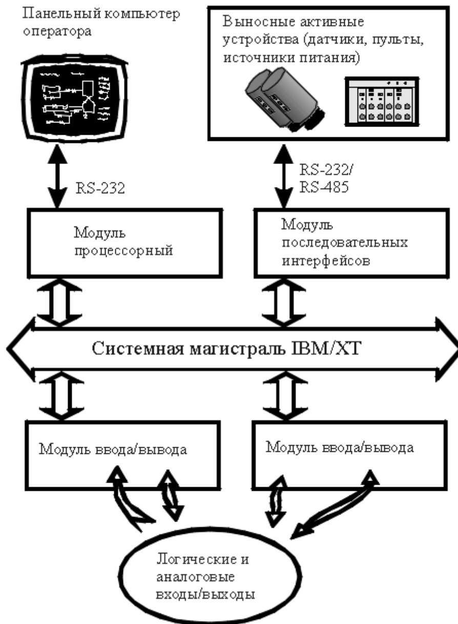
Рис. 2. Структурная схема крейта КПУ.
