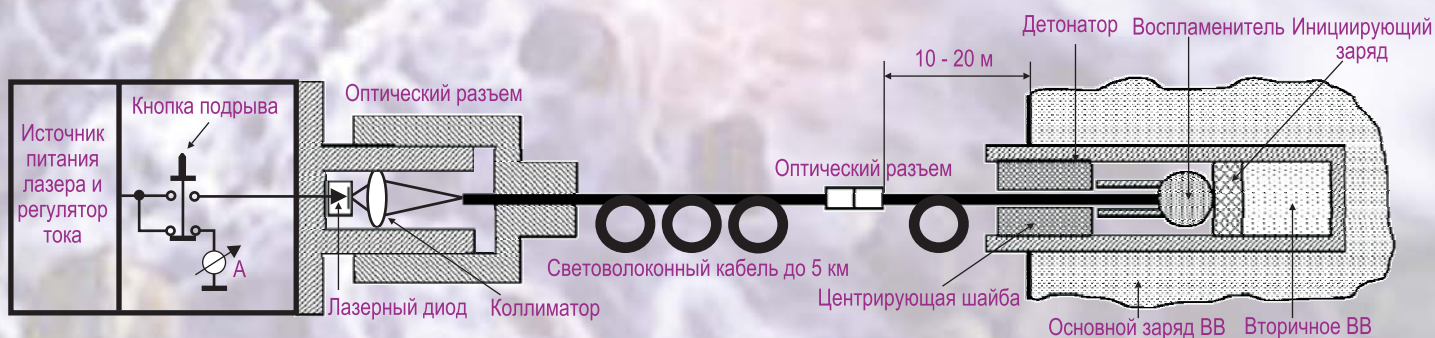
Функциональная схема электробезопасной лазерной системы инициирования ВВ
