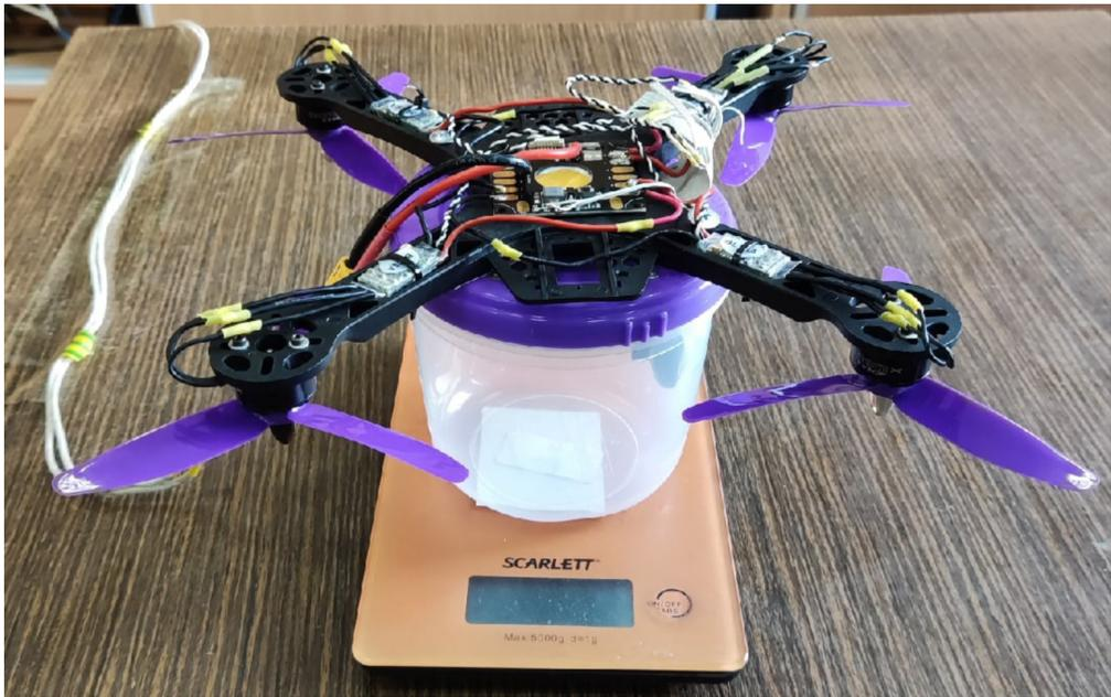
Рис 4.3: Стенд измерения зависимости тяги от длительности ШИМ-сигнала
