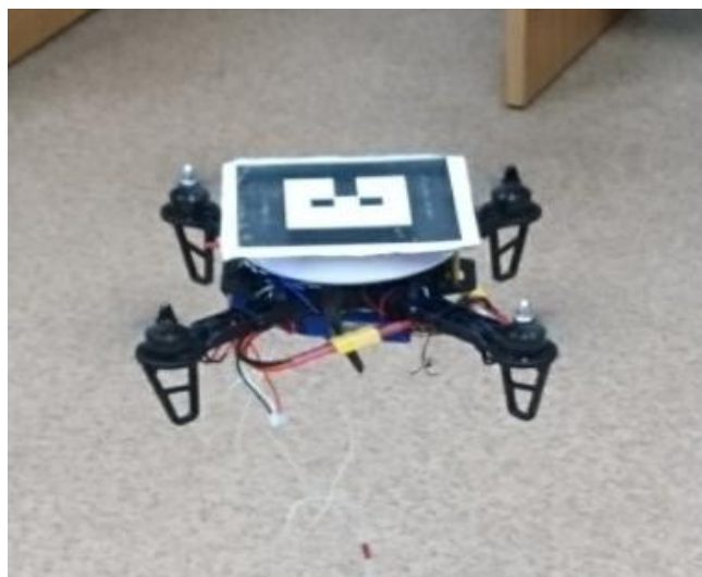
Рисунок 3 – Маркер для системы визуального позиционирования, закрепленный на квадрокоптере
