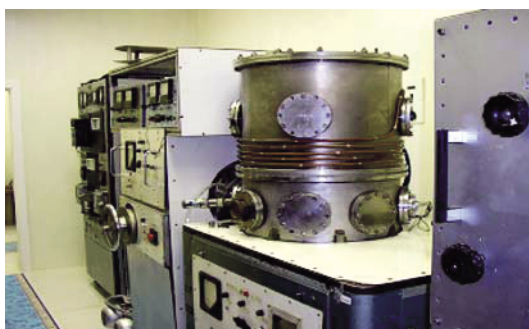
Рис. 3. Одна из семейства высоковакуумных технологических установок, изготовленных на Опытном заводе СО РАН в 1963–1964 гг.
