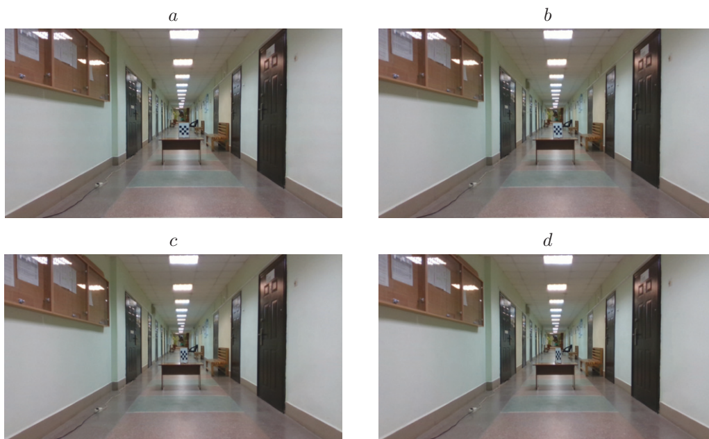
Рис. 1. Пример набора снимков объекта со стороной квадрата 48 мм на расстоянии 5 м под углами 0 (a), 30 (b), 45 (c) и 60° (d) к картинной плоскости
