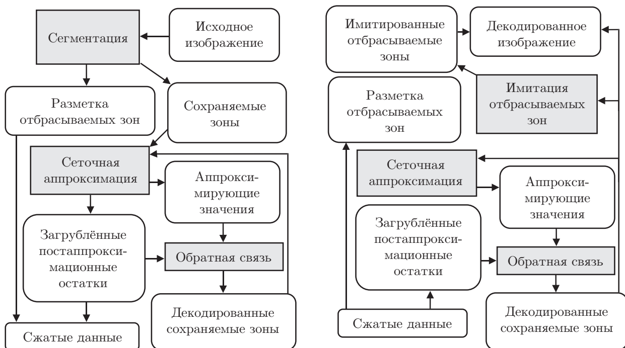
Рис. 1. Архитектура предложенной технологии сжатия изображений, основанной на машинном обучении
