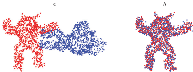
Рис. 3. Регистрация облаков точек: a — облако точек P (красное), облако точек Q (синее); b — результат регистрации
