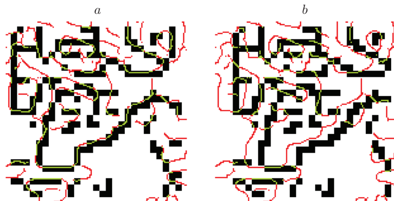
Рис. 3. Результат совмещения контуров ГСИ и ПИ: a — точное совмещение, b — совмещение с ошибкой
