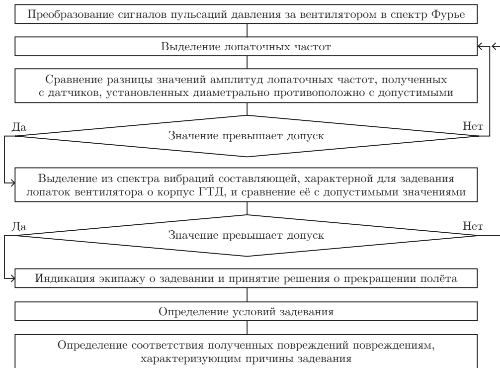
Рис. 6. Алгоритм идентификации задевания рабочих лопаток вентилятора о корпус ГТД и определение причин их возникновения
