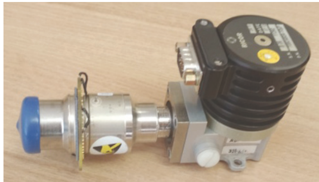
Рис. 2. ФПУ PLUTON LW с микрокриогенной машиной К 508
