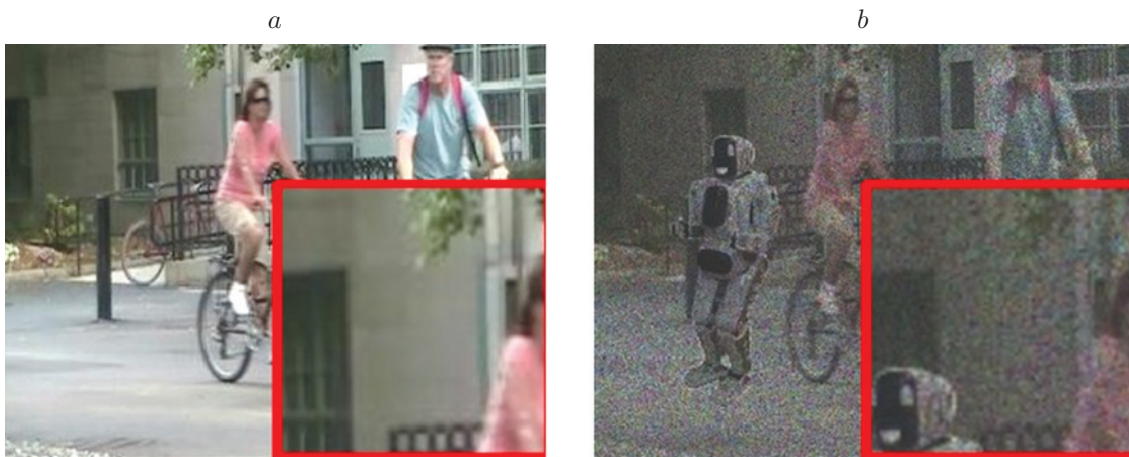
Рис. 2. Модификация видеокadres: a — пример исходного кадра из видеопотока; b — кадр из видеопотока после добавления статичного объекта, похожего на человека, и умножения на гауссовский шум ( \mu = 0,8 , \sigma = 0,2 )
