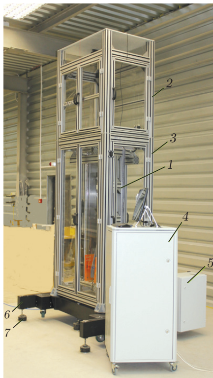
Рис. 8. Общий вид установки «Струна»: 1 — линейный привод, 2 — блок оптический, 3 — рама, 4 — стойка управления, 5 — блок электроники, 6 — основание, 7 — опора
