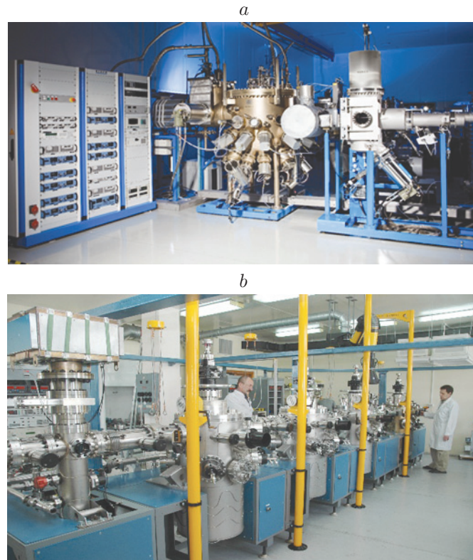
Рис. 1. СВВ-установки для выращивания ГЭС КРТ МЛЭ: a — МВЕ 49 (Riber) [2]; b — «Объ-М» (ИФП СО РАН) [3]
