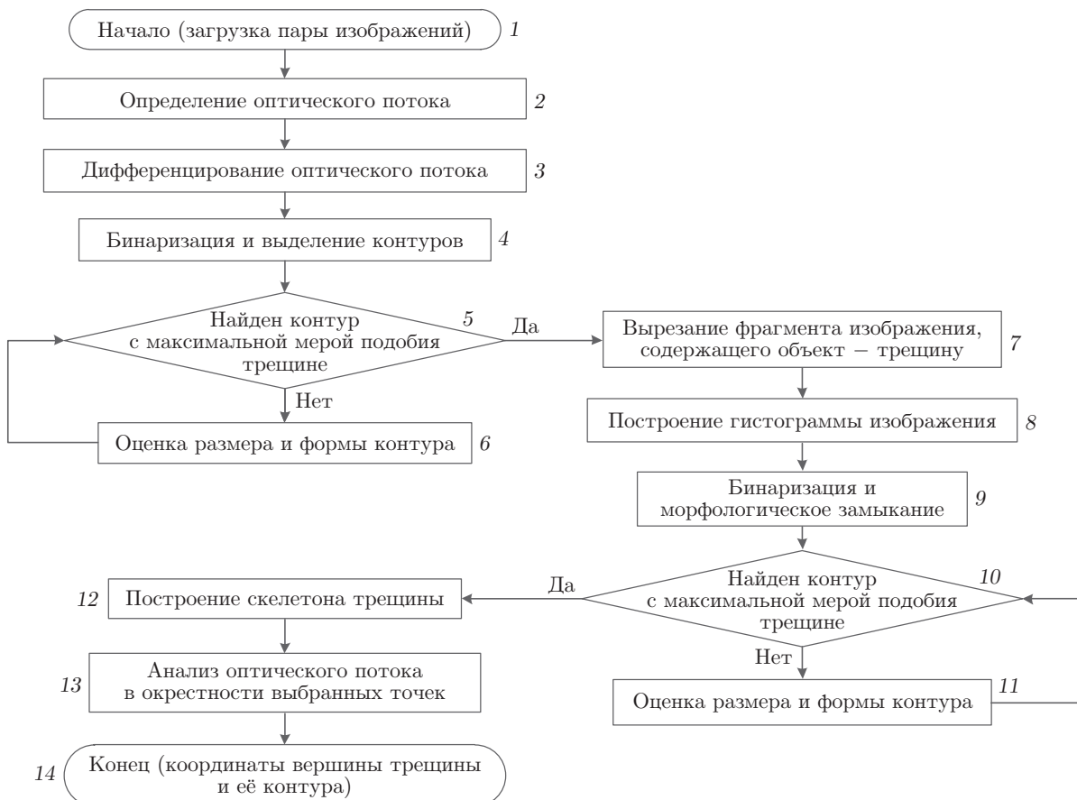
Рис. 1. Алгоритм выделения трещины и определения координат её вершины
