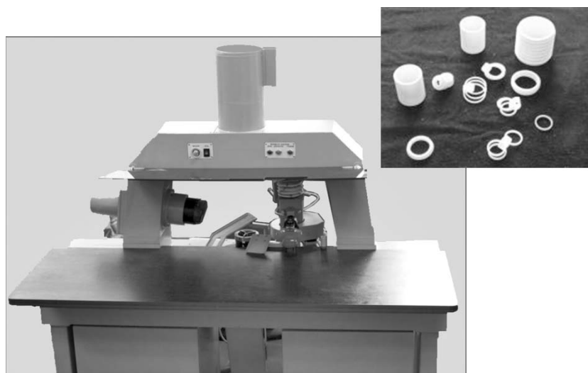
Рис. 5. Оптико-электронная система «Кольцо» для 3D-контроля геометрических параметров кольцевых керамических изделий
