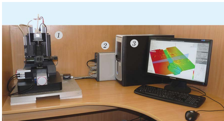
Рис. 9. Общий вид микро/нанопрофилометра: 1 — оптико-механический блок, 2 — контроллер управления, 3 — компьютер
