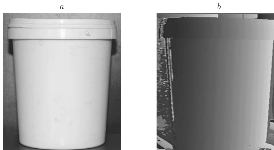
Рис. 7. Результаты эксперимента: a — фотография объекта, b — его восстановленный трёхмерный профиль (значения интенсивности соответствуют значениям z -координаты профиля)
