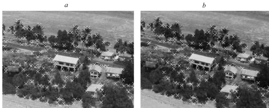
Рис. 1. Стереопара видеокадров: a – первый кадр с точками, выделенными оператором Харриса; b – второй кадр с соответственными точками, найденными коррелятором
