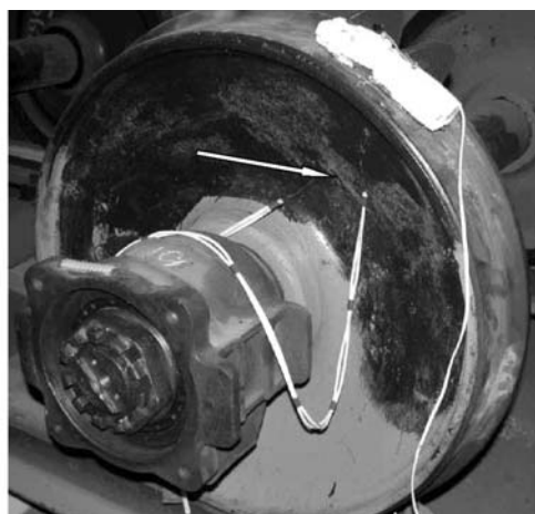
Рис. 6. Общий вид железнодорожного колеса со сквозным дефектом
