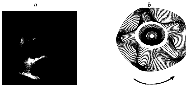
Рис. 5. Визуализированный при косом освещении динамический рельеф поверхностных волн (пятилучевая структура) (а). Амплитуда волны \sim 0,3 мм. Качественное представление пятилучевой структуры динамического профиля поверхностных волн (без соблюдения масштаба) (b)
