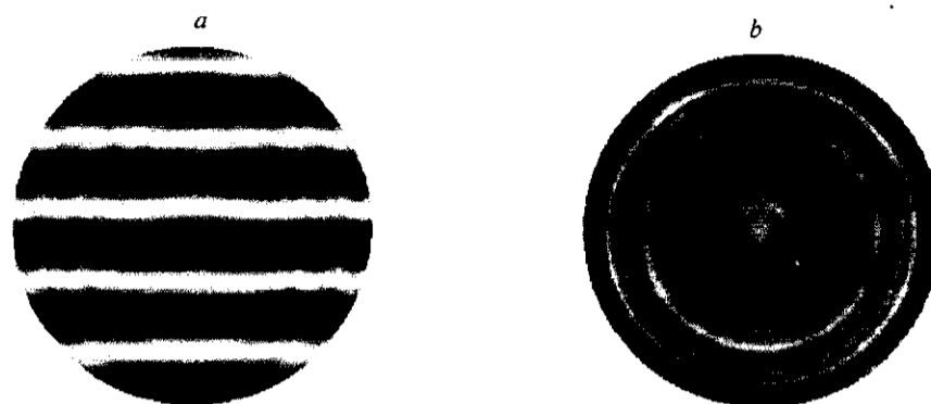
Рис. 17. Интерферограмма волнового фронта зонной пластинки (диаметр 58 мм, f/1,1 ), полученная в интерферометре Физо (а), и теневая карта ошибки фазы в пределах \pm \lambda/20 (б)
