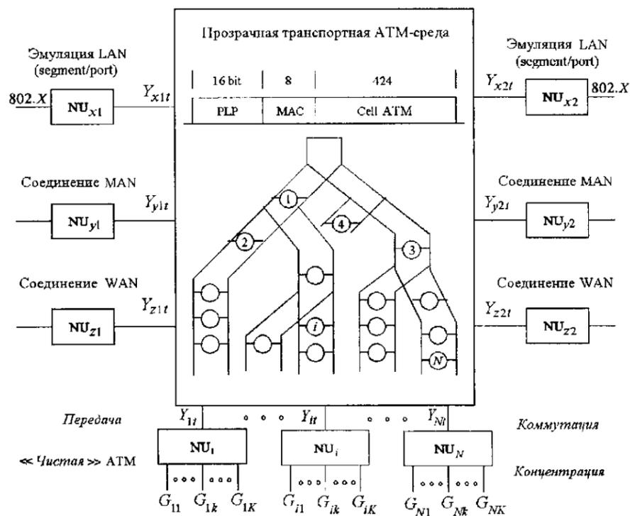
Рис. 2. Модель распределенной мультисети ATM
