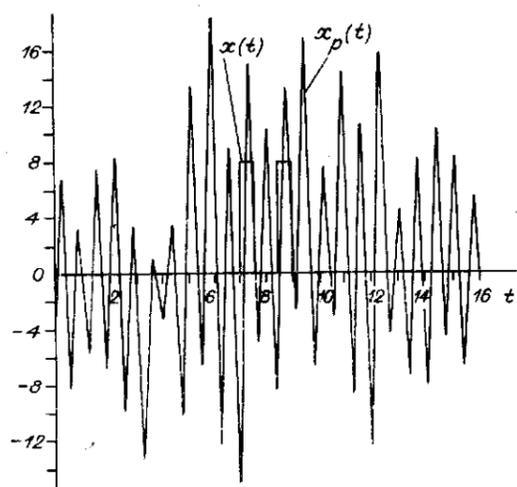
Рис. 1. Реставрация методом инверсной фильтрации при квантовании выходного сигнала  $y(t)$
