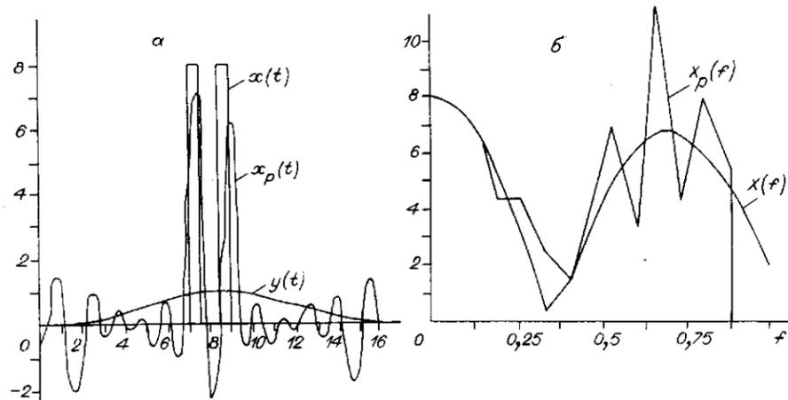
Рис. 2. Реставрация методом инверсной фильтрации с ограничением полосы частот при квантовании выходного сигнала  $y(t)$ : результаты реставрации во временной (а) и в частотной (б) областях
