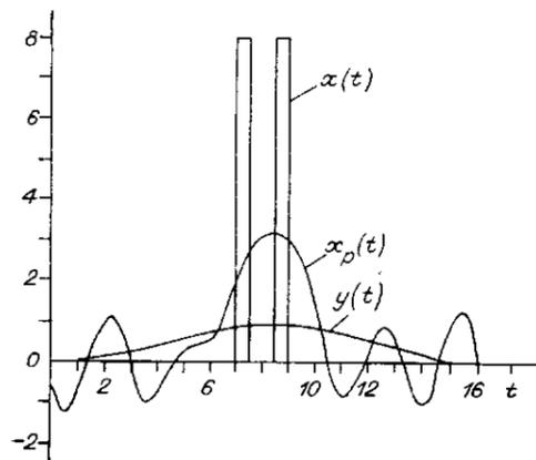
Рис. 4. Реставрация методом Тихонова при наложении внешней помехи на выходной сигнал  $y(t)$
