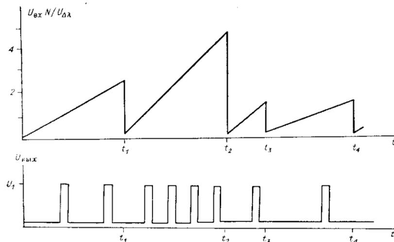
Рис. 4. Эпюры напряжений, иллюстрирующие работу многоуровневого оптического элемента в регулируемом умножителе частоты:
