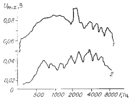
Рис. 3. Амплитудно-частотная характеристика датчика (1) и мембраны (2)
