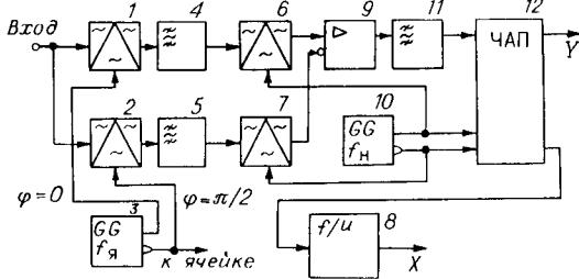
где  $f_n = 75$  МГц — частота питания акустооптической ячейки;  $f_d$  — доплеровский сдвиг частоты. Эти импульсы поступают на перемножители (смесители) 1 и 2. На вторые их входы подаются синусная и косинусная составляющие от генератора 3, питавшего акустооптическую ячейку:
