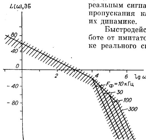
Рис. 4. Логарифмическая амплитудно-частотная характеристика разомкнутого контура регулирования
