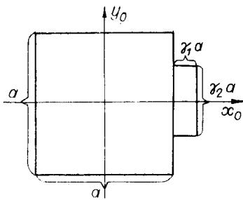
Для экспериментальной проверки предложенного метода использовалась установка, аналогичная [2], с соблюдением исходных параметров, принятых в расчете. Эталонный объект — бипарный квадрат со стороной  $a = 1$  мм; исследуемый объект — прямоугольник, отличающийся от исходного объекта добавкой с коэффициентами  $\gamma_1 = 0,1$  и  $\gamma_2 = 1$ . Экспериментальные значения  $\beta_n$  также приведены в таблице.
