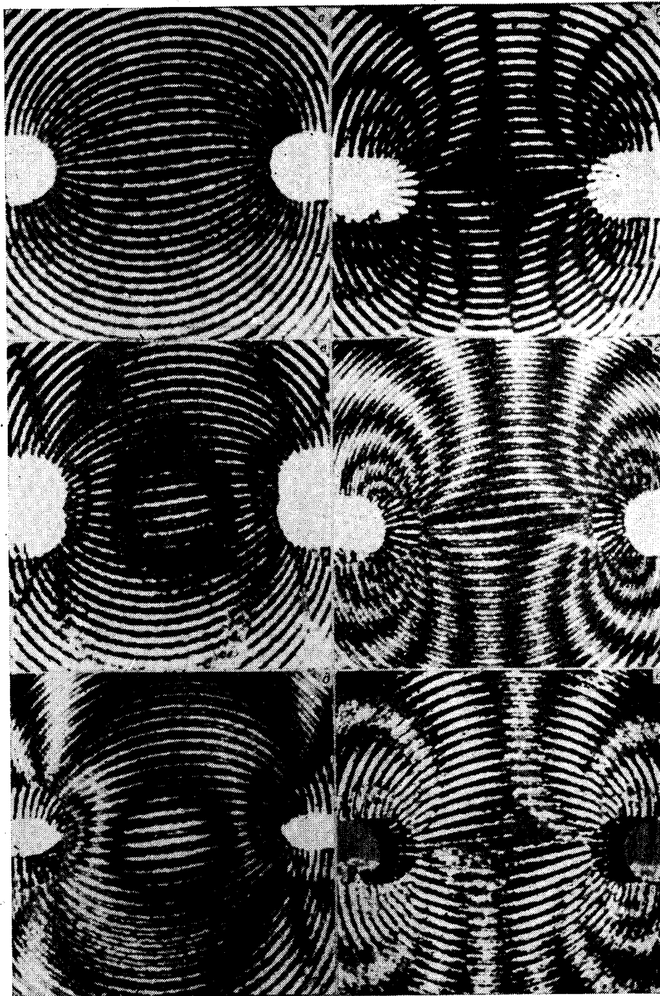
Рис. 5. Преобразование реальной зашумленной исходной интерферограммы (а) с помощью муарограмм M_s (б, в); M_f (г, д); M_{fc} (е)
