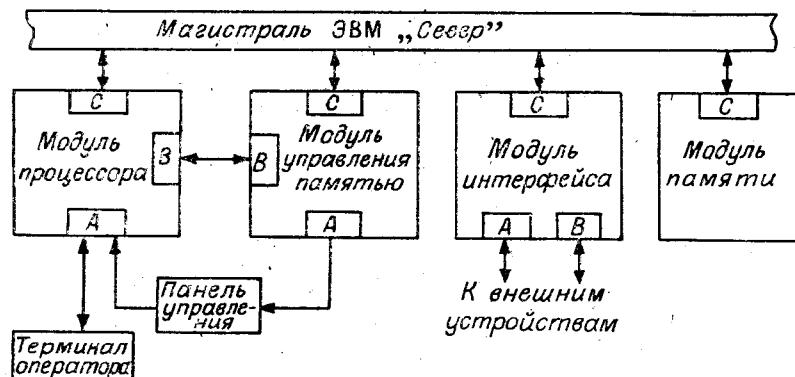
ными числами с плавающей точкой. Блок адресной арифметики процессора формирует 16-разрядный адрес, при этом управление адресной арифметикой осуществляется микропрограммно. За счет использования модуля управления памятью (диспетчера памяти) число разрядов адреса увеличивается до 24, что позволяет адресоваться к 32 Мбайт оперативной памяти.
