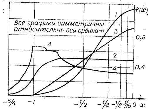
Как показало цифровое моделирование, примерно на 4–5-м отсчете закон распределения ошибок квантования стабилизируется. При цифровом моделировании использовались стационарные случайные процессы со следующими одномерными законами распределения их мгновенных значений:
