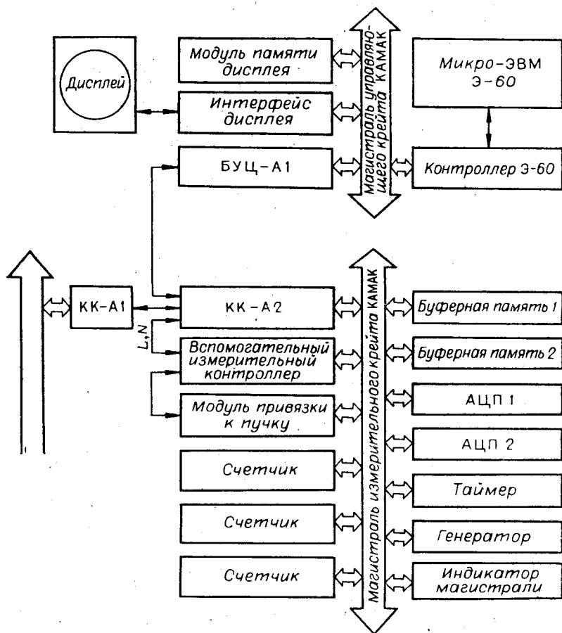
2. Система состоит из стандартных модулей NIM и КАМАК, что открывает возможности использования разработок различных организаций и фирм, работающих в этих направлениях.
