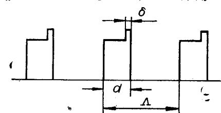
Найдем число исходных элементов  $N = 2D/\Lambda$ , необходимое для наблюдения их мультипликации на отрезке  $2|x_{\max}|$ , равном  $N_1 \Lambda$ , хотя бы в одной плоскости  $z_{0,n}$ . Для этого воспользуемся неравенством (8), в которое подставим значение  $z_{0,n} = L/n$ . Тогда будем иметь  $N > N_1 + 2(m + 1/n)\Lambda/\delta$ .
