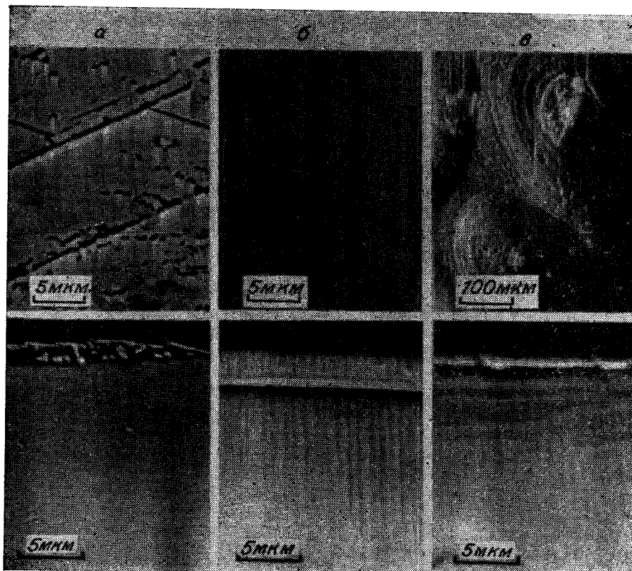
Рис. 7. Электронная микрофотография поверхности твердых растворов \text{In}_{0,76}\text{Ga}_{0,24}\text{As}_{0,54}\text{P}_{0,46} на (111)В InP и границы раздела буферный слой — твердый раствор на сколе с различным рассогласованием параметра решетки \Delta a_{\perp}/a , %:
