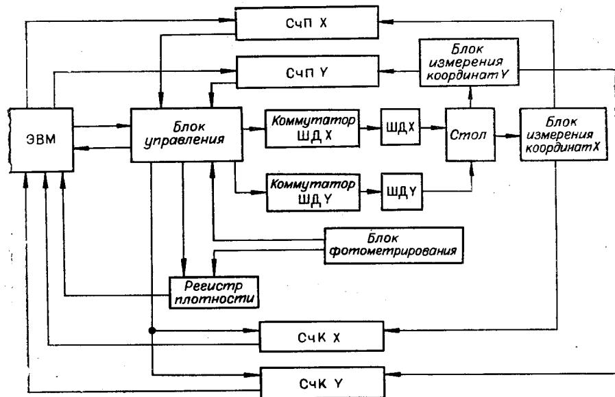
Перед началом работы в автоматическом режиме из ЭВМ через блок сопряжения и приемник выходных сигналов выдается команда для приведения в исходное состояние всей системы. Далее по программе из ЭВМ через блок сопряжения в счетчики перемещений СчПХ и СчПУ заносятся коды перемещения  $X$  и  $Y$  с учетом направления перемещения.
