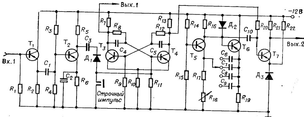
должен превышать  $84^\circ$ . Шаг развертки равен 0,4 мм. Рабочая скорость считывания 2 орд/с. Погрешность считывания единичной ординаты не более  $1\%$  и определяется нестабильностью частоты генерируемых импульсов. В зависимости от масштаба записи устанавливается частота генерируемых импульсов от 200 Гц до 10 кГц переключением емкостей  $C_6$ — $C_9$  и переменным сопротивлением  $R_{18}$ .
