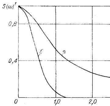
марного спектра сигнала на выходе демодулятора спектр шума, полученный при той же скорости на ламинарном потоке.
