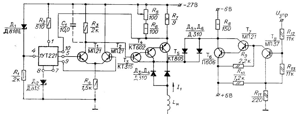
В качестве диодов ключа в первых трех разрядах применены импульсные диоды Д310. В младших разрядах, начиная с четвертого, где выходной ток меньше, используются кремниевые диоды с пренебрежимо малым обратным током.
