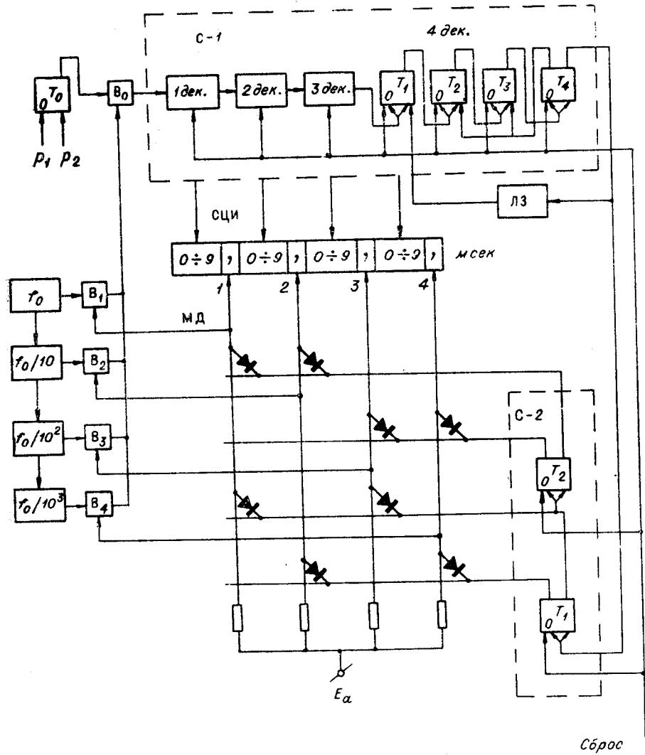
хода  $T_0$  открывает вентиль  $B_0$ , давая доступ к счетчику С-1 импульсам опорной частоты. В каждый момент открывается один из вентилей  $B_1$  —  $B_4$ , давая доступ к счетчику лишь одной опорной частоте. Открытие того или другого вентиля определяется кодом, записанным в счетчике числа переполнений С-2. Зависимость открывания вентилей от состояния триггеров  $T_1$  и  $T_2$  счетчика С-2 приведена в кодовой таблице.
