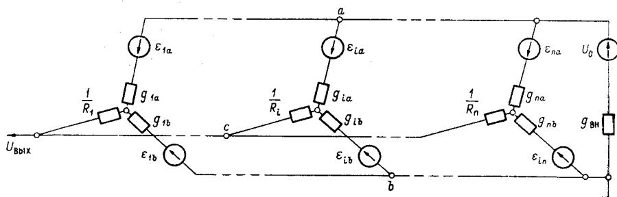
На рисунке калиброванное сопротивление  $R_i$  подключается к шинам  $a$  или  $b$  с помощью ключей, имеющих остаточные напряжения  $\epsilon_{ia}$ ,  $\epsilon_{ib}$  и сопротивления  $r_{ia} = \frac{1}{g_{ia}}$ ,  $r_{ib} = \frac{1}{g_{ib}}$ .
