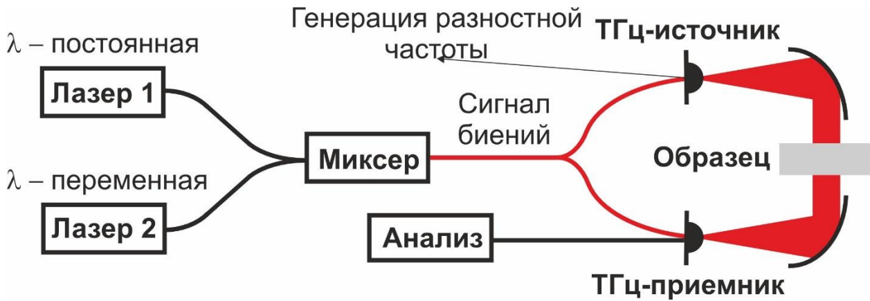
Рисунок 4.1. Блок-схема установки для проведения ТС.
