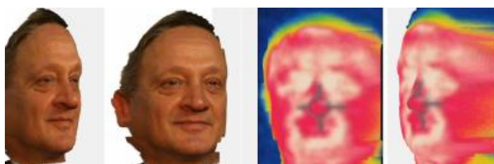
Рисунок 2 – Две проекции 3D изображения в видимом диапазоне и две – в ИК, синтезированные по двум двумерным картинам – картине текстуры и картине топографии поверхности (маске), синтезированной в видимом диапазоне
