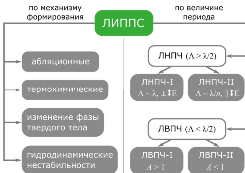
Рис. 7. Классификация ЛИППС по физическому механизму их образования, либо по отношению величины периода \Lambda к длине волны \lambda падающего излучения, ориентации относительно линейной поляризации \downarrow E и отношению глубины модуляции к периоду A .
