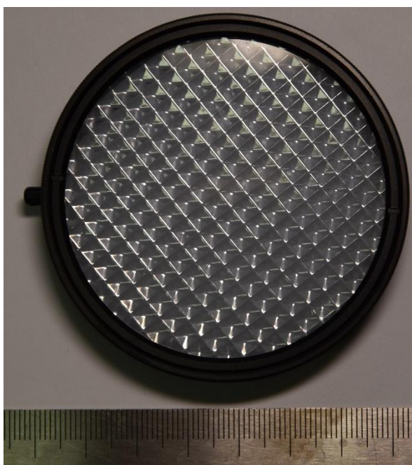
Рисунок 11 — Фотография светорассеивающего фильтра. Данный фильтр используется для получения «белого изображения» камерой светового поля.
