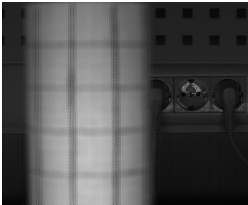
Рисунок 15 — Пример изображения, перефокусированного на задний фон.
