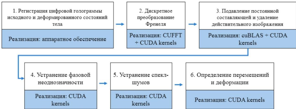
Рисунок 5.2.7 – Этапы цифровой голографической интерферометрии и их реализация
