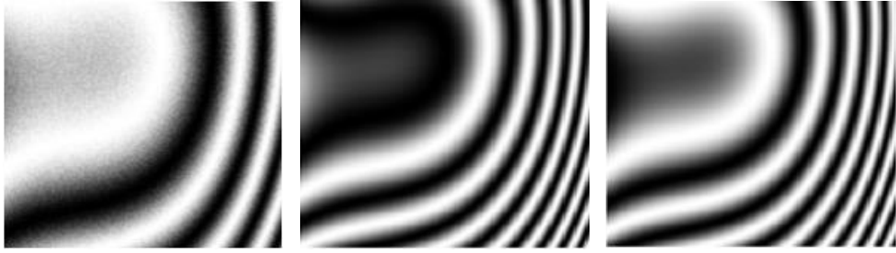
Рисунок 3.1.6 – Первая серия интерференционных картин с фазовыми сдвигами \delta_1 = -90^\circ , \delta_2 = 0^\circ и \delta_3 = -90^\circ (слева направо)
