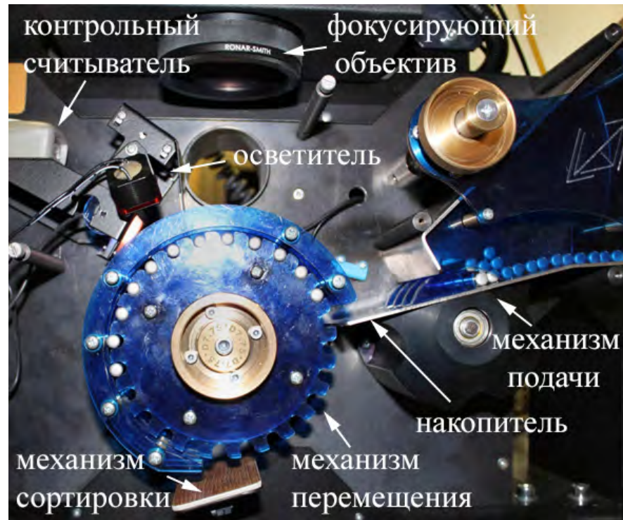
Рисунок 4.8 Внешний вид электромеханической части устройства
