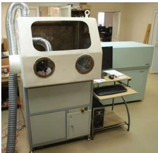
Рис. 97. Внешний вид защитного химического бокса с установленным внутри ИВС с МП и спектральным прибором «Гранд».
