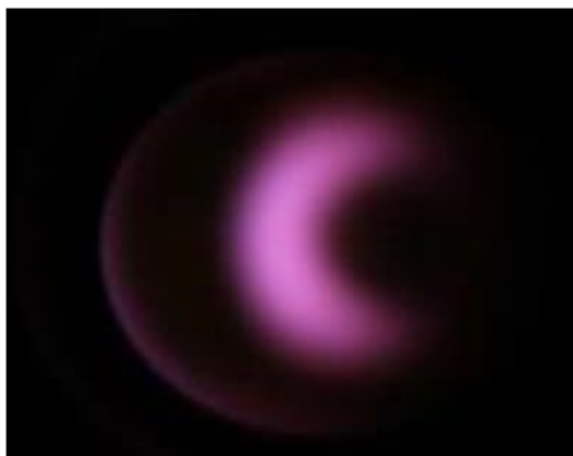
Рис. 6. Форма микроволновой азотной плазмы спектрометра Agilent MP-AES 4100 при аксиальном способе наблюдения [31].
