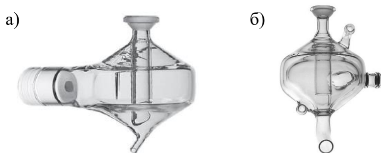
Рис. 40. Фото циклонной распылительной камеры «Double-Pass» и циклонной распылительной камеры с рубашкой [87].
