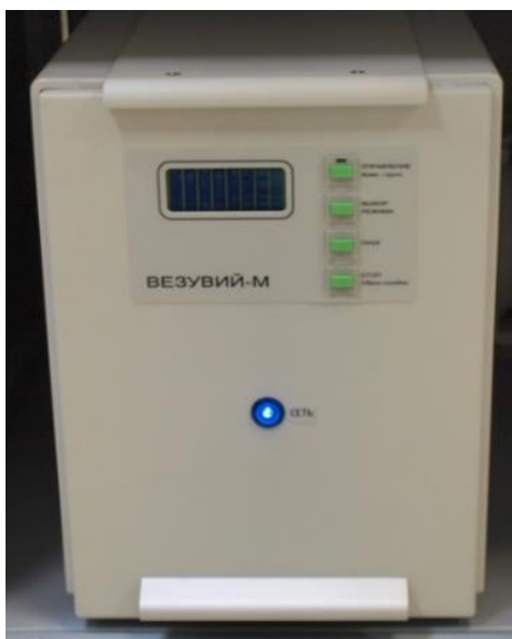
Рис. 18. Фотография (слева) и блок-схема (справа) модернизированного генератора «Везувий-3», используемого для питания СВЧ магнетрона [67].
