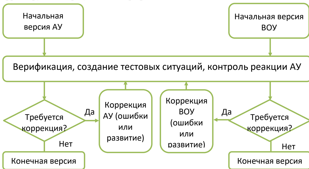
Рис. 1. Общая схема динамической верификации алгоритмов управления технологическим объектом: АУ – алгоритм управления, ВОУ – виртуальный объект управления.
