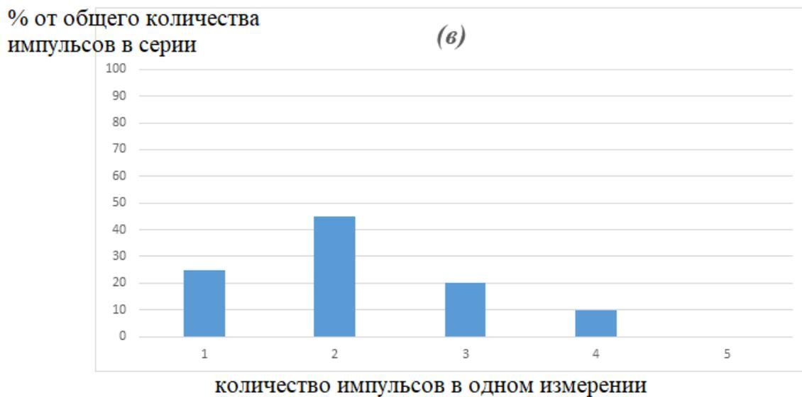
Рисунок 5. Статистика импульсов синхронизации мод. **(a)** – при  $\Delta L = 0$ ; **(б)** – при  $\Delta L = 300$  мкм; **(в)** – при  $\Delta L = 700$  мкм [120].
