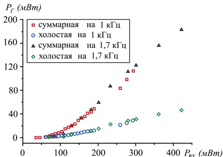
Рисунок 5. Зависимость выходной мощности  $P_{Г}$  от входящей в кристалл мощности накачки  $P_{ВХ}$  при частоте повторения 1 и 1,7 кГц.
