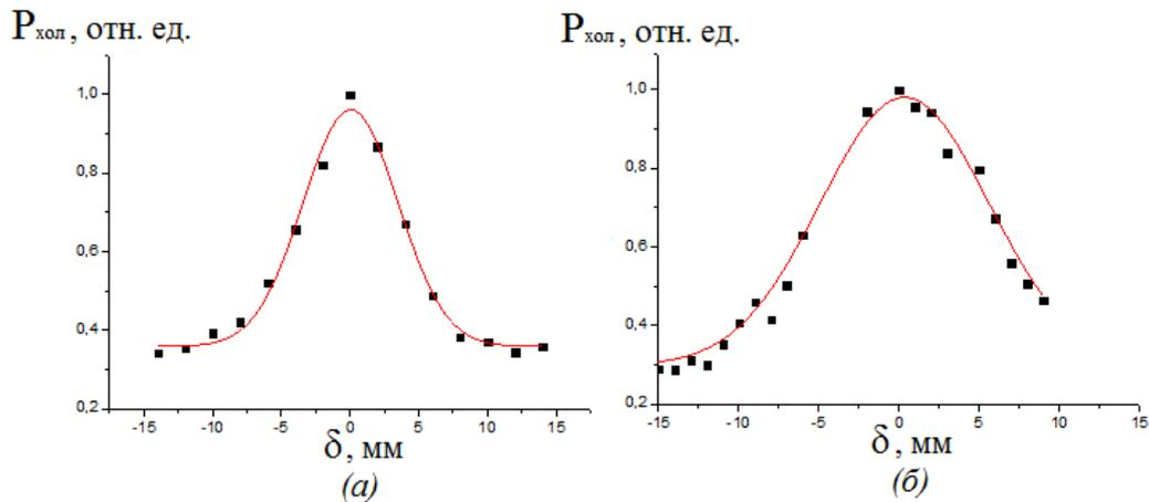
Рисунок 2. Зависимость относительной выходной мощности холостой волны  $P_{хол}$  от  $\delta$  изменения длины резонатора ПГС. (а) – при  $\Delta L_H=300$  мкм; (б) – при  $\Delta L_H=700$  мкм.
