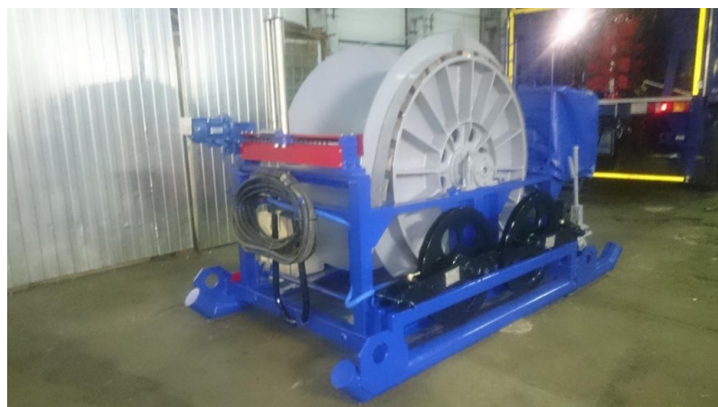
Рисунок 3.23. Устройство вымотки кабеля.
