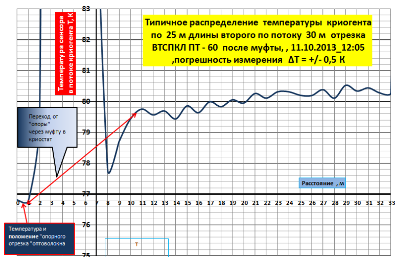
Рисунок 3.20. Профиль температуры криогенга вдоль ВТСПКЛ ПТ в квазистабильном режиме.
