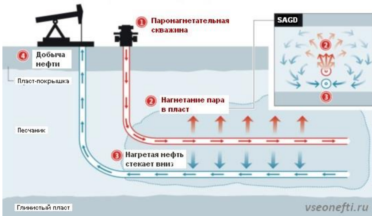
Рисунок 3.24. Технология добычи высоковязкой нефти.
