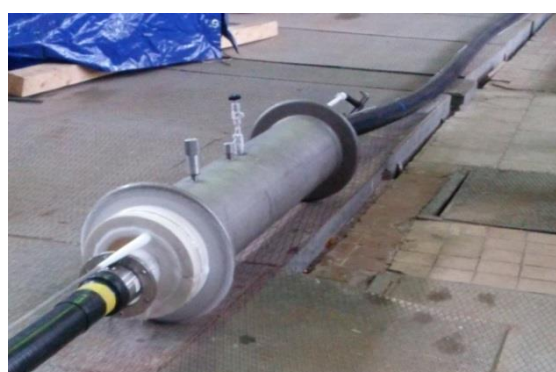
Рисунок 3.17. Отрезки ВТСПКЛ длиной 30 м и промежуточная муфта.
